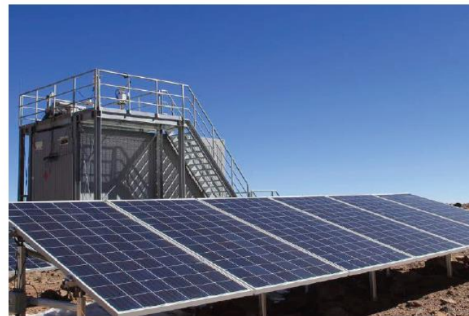
Sistema de medición de soiling en la meseta de Chajnantor (junto al observatorio ALMA).
